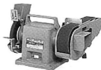
(d) エンドレス研磨布が破れた状態で研磨をしない。
