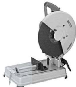
(e) 砂石は薄く、割れやすいので必要以上の力で押し付けて切斷しないように注意する。
